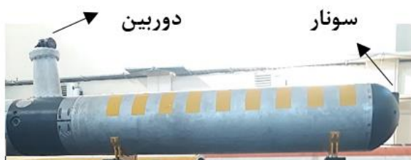
شکل ۱- نمایی از AUV مجهز به سونار جلونگر و دوربین
